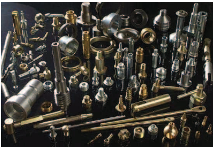
7.2 1: Προϊόντα μαζικής παραγωγής σε μηχανές CNC. Περιλαμβάνουν κοχλίες, μαστούς υδραυλικών εγκαταστάσεων κ.α.
