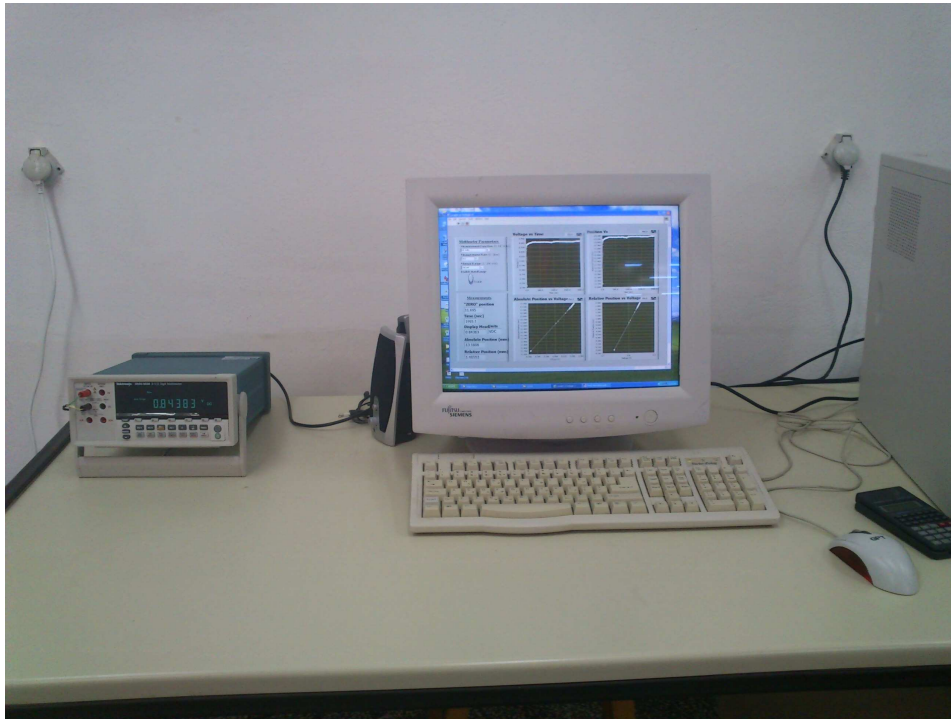
Σχήμα 3.4 Διασύνδεση (interface) μηκυσιόμετρου-βολτόμετρου με υπολογιστή για την καταγραφή του μήκους συναρτήσει του χρόνου.
