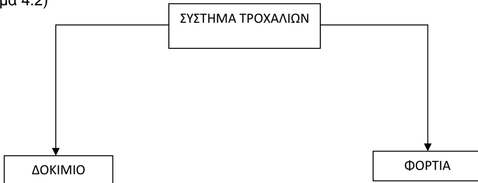
Σχήμα 3.2 Διαγραμματική απεικόνιση αρχής λειτουργίας της συσκευής ερπυσμού που κατασκευάστηκε στο εργαστήριο Τεχνολογίας Υλικών.
