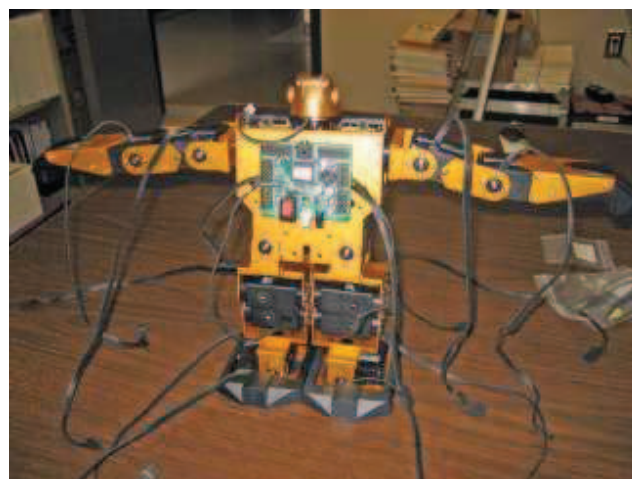
Εικόνα 14. Τοποθέτηση του ελεγκτή (controller)
