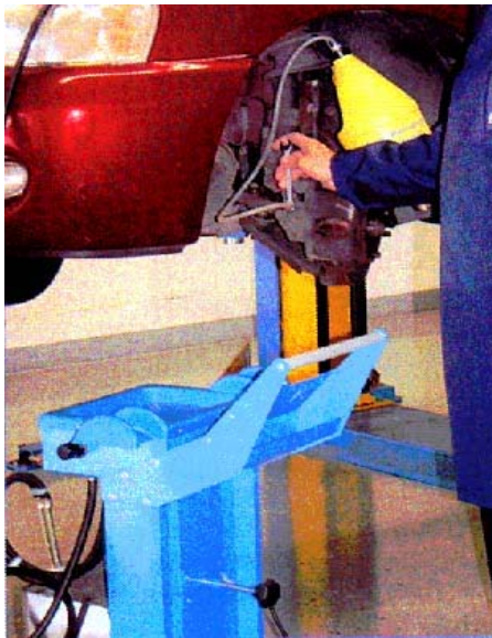
Εικόνα 2-32. Περισυλλογή υγρών φρένων για ανακύκλωση.
