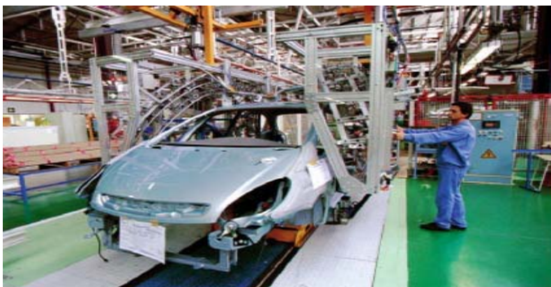
Εικόνα 2-9. Κατασκευή ενιαίων πλαισίων για εύκολη ανακτησιμότητα.
