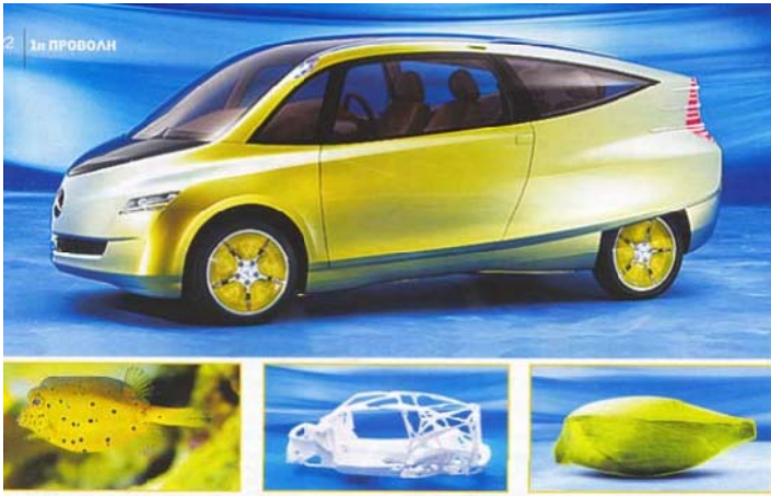
Εικόνα 1-18. Πειραματική πρόταση οχήματος με ιδιαίτερα αεροδυναμικό αμάξωμα εμπνευσμένο από το σχήμα ψαριών.
