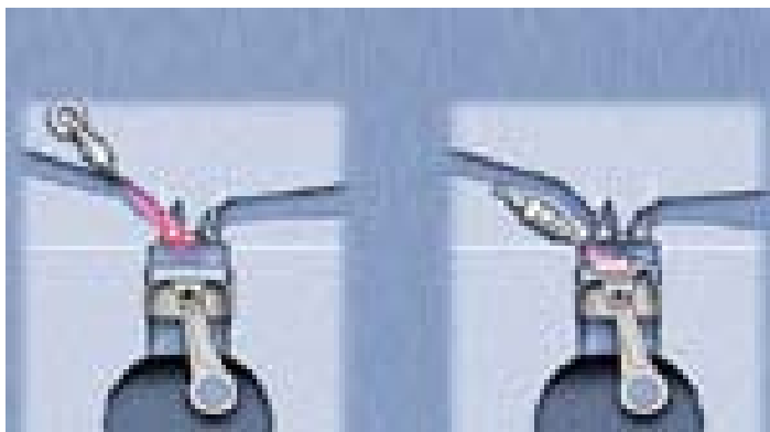
Εικόνα 1-11. Η βασική διαφορά ανάμεσα στα συμβατικά συστήματα και στα συστήματα άμεσου ψεκασμού είναι ότι το καύσιμο ψεκάζεται απευθείας στο θάλαμο καύσης
