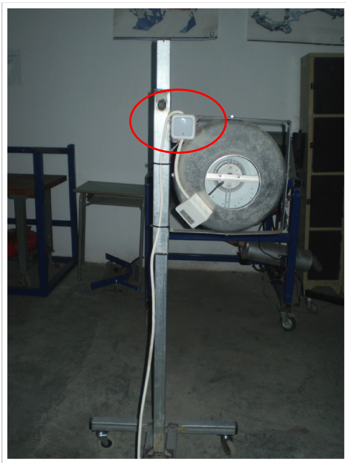
Εικόνα 7.8 : Απεικόνιση ηλεκτρικού διακόπτη εξωτερικού τύπου για την εκκίνηση και τη διακοπή λειτουργίας του μοτέρ.
