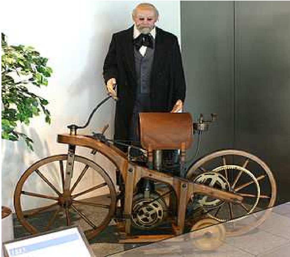
Το πρώτο μηχανάκι με μετάδοση κίνησης με ζιάνα
