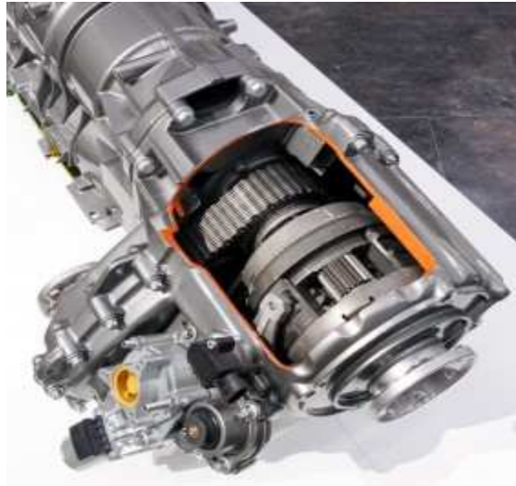
Το επικυκλικό κεντρικό διαφορικό του Land Rover Discovery της Magna Steyr
