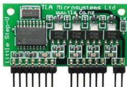
Εικόνα 4 stepper driver της Microsystems
