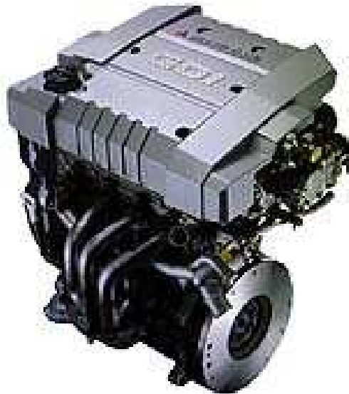
Σχήμα 7.2: Κινητήρας 4G93 GDI της Mitsubishi Motors
