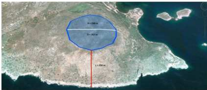
Εικόνα 24: Εδώ απεικονίζετε το μήκος του σωλήνα, διάμετρος δεξαμενής υψομετρική διαφορά της πάνω δεξαμενής με την κάτω (θάλασσα).
