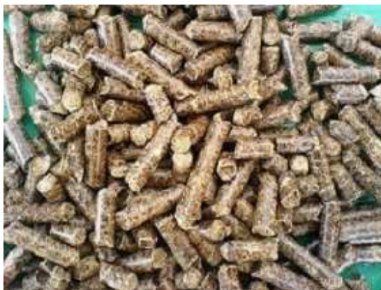
Εικόνα 9: Μια μορφή βιομάζας: pellet (συσσωματώματα) τα οποία προκύπτουν από τη μηχανική συμπίεση πριονιδιού, χωρίς την προσθήκη χημικών ή συγκολλητικών ουσιών.
