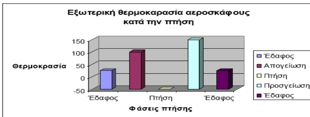
Σχήμα 2.4: Οι εναλλαγές στην εξωτερική θερμοκρασία του αεροσκάφους αποτελούν ένα είδος θερμικού σοκ.
