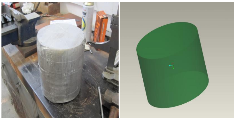
Εικόνα 230: Ακατέργαστο τεμάχιο αλουμινίου – σχεδιασμένο ακατέργαστο τεμάχιο
