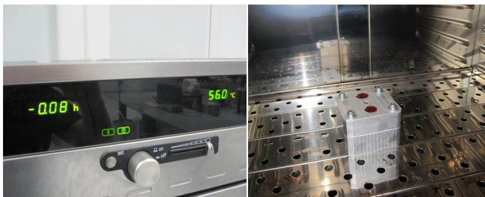
Εικόνα 271: Προσθήκη καλουπιού στο φούρνο
