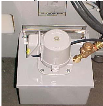
Εικόνα 284: Μονάδα ψυκτικού υγρού
