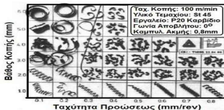
Εικόνα 17:Είδη αποβλήτου ανάλογα με την ταχύτητα προώσεως και του βάθους κοπής
