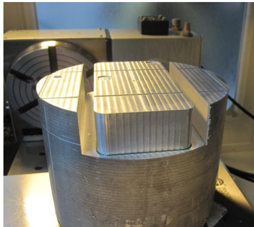
Εικόνα 238: Αποτέλεσμα αφαίρεσης υλικού περιμετρικά των πλακών του καλουπιού
