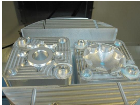
Εικόνα 259: Αποτέλεσμα φινιρίσματος της πλάκας πυρήνα
