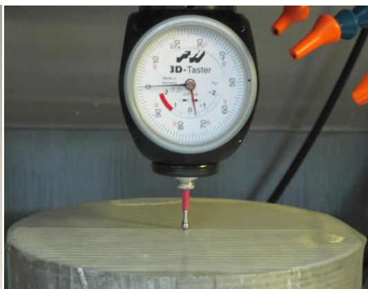
Εικόνα 233: Δήλωση σημείου μηδέν στο CONTROLLER της εργαλειομηχανής
