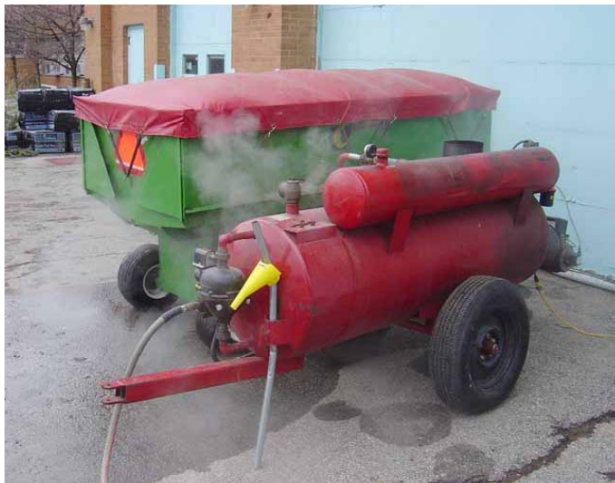
Εικόνα 15: Ατμογενήτρια που χρησιμοποιείται για την απολύμανση εδάφους.
