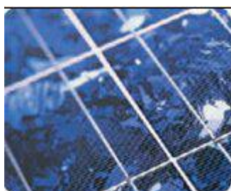
Εικόνα 7: Φ/Β στοιχείο πολυκρυσταλλικού πυριτίου
