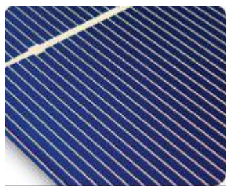
Εικόνα 6: Φ/Β στοιχείο μονοκρυσταλλικού πυριτίου
