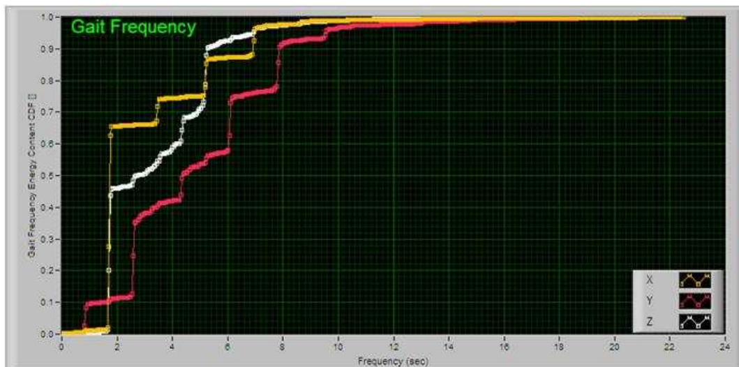
Εικόνα 5.6: Παράδειγμα βάδισης με Ταχύτητα 3.5(Km/h) και συχνότητα δειγματοληψίας με μείωση δεδομένων AAAA(46)Hz. Εμφανίζονται συχνότητες από 0 έως 23Hz, και ποσοστό αθροιστικής ενέργειας από 0 έως 100%.
