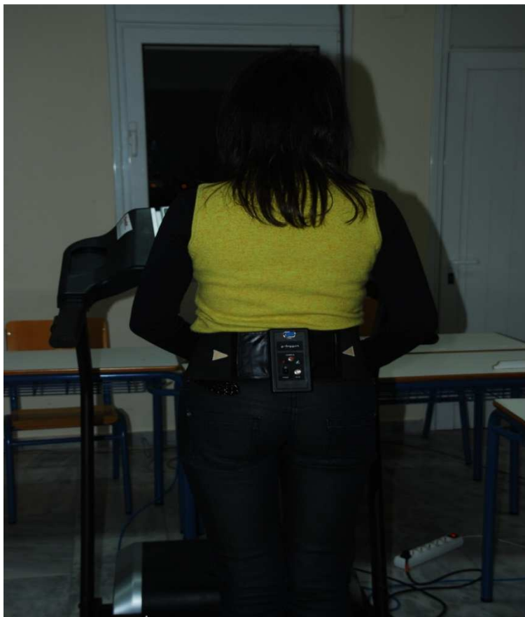
Εικόνα 0.8: Το επιταχυνσιόμετρο τοποθετημένο πάνω στον εξεταζόμενο
