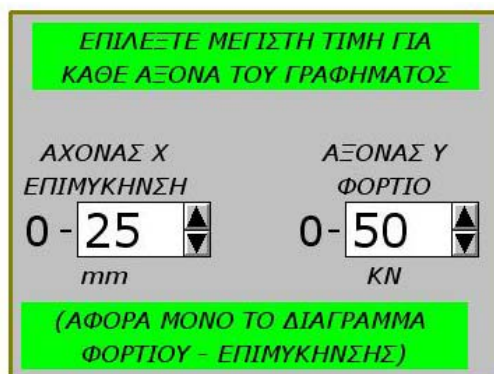
Σχήμα 4.22: Τμήμα της οθόνης ρυθμίσεων 1 για ρύθμιση των μέγιστων τιμών των αξόνων του διαγράμματος φορτίου - επιμήκυνσης
