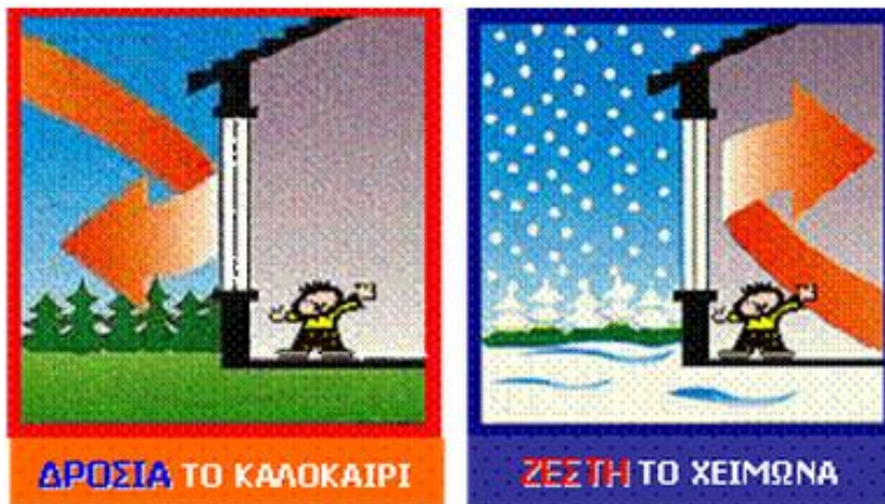
Εικόνα 48. Σημασία επιλογής κατάλληλου συστήματος υαλοπίνακα
