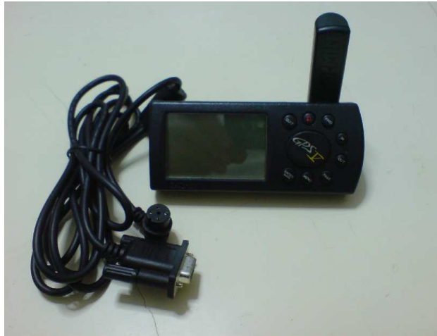
Εικόνα 5.1 Ο δέκτης GPS V της Garmin με την ενσωματωμένη κεραία και το καλώδιο επικοινωνίας με τον υπολογιστή.
