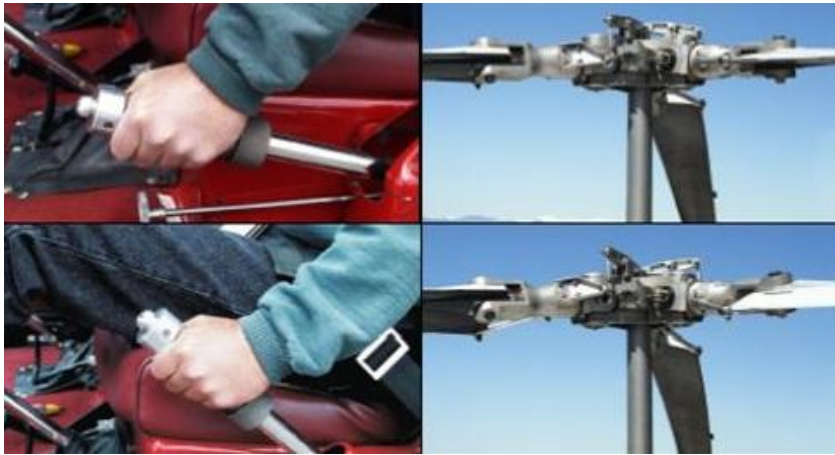
Σχ. 2.2 Μοχλός συλλογικού βήματος κύριου στροφείου
