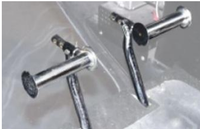
Σχ. 2.3 Ποδοστήρια ουραίου στροφείου
