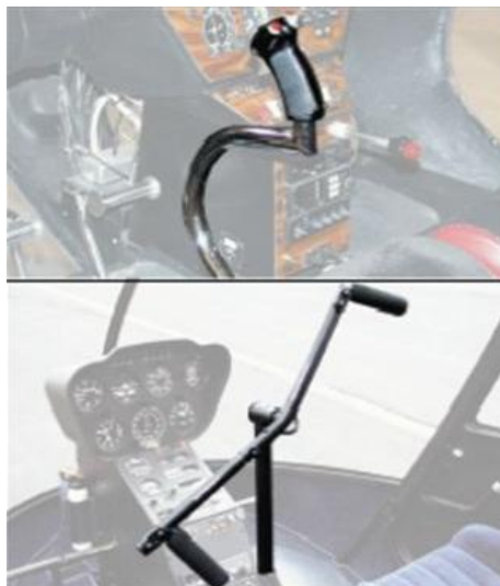
Σχ. 2.1 Μοχλός κυκλικού βήματος κυρίως στροφείου
