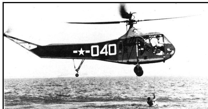
Σχ. 1. 11 Επιχείρηση διάσωσης από το Αμερικανικό Ναυτικό με ένα HNS-1 (R-4B) ελικόπτερο της Sikorsky.
