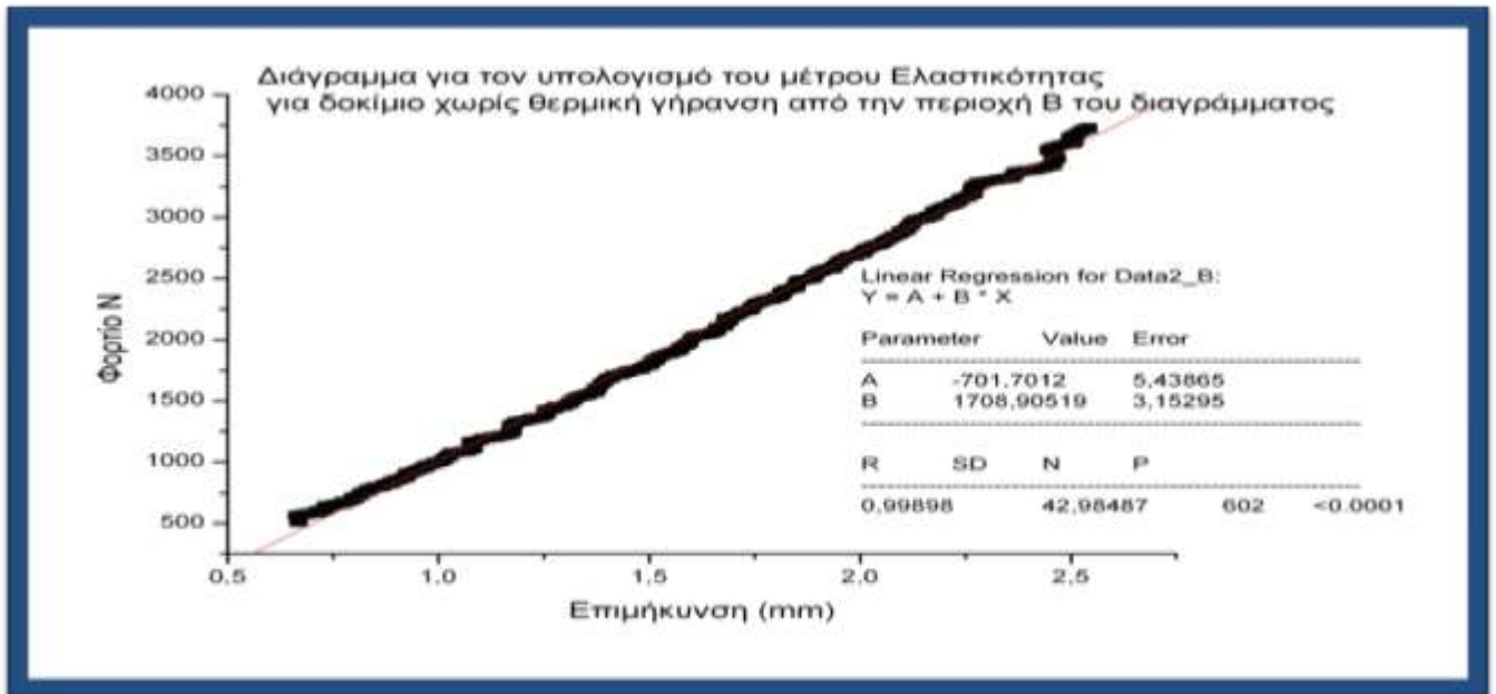
Διάγραμμα για τον υπολογισμό του μέτρου ελαστικότητας για δοκίμιο χωρίς θερμική γήρανση από την περιοχή B του διαγράμματος
