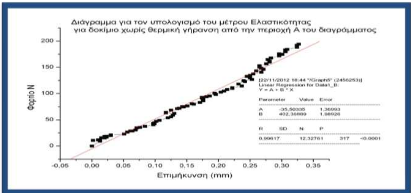
Διάγραμμα για τον υπολογισμό του μέτρου ελαστικότητας για δοκίμιο χωρίς θερμική γήρανση από την περιοχή A του διαγράμματος
