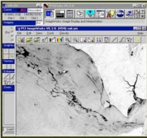
Εικόνα : 2.7 Πετρελαιοκίλιδα από radar εικόνα με χρήση του FSPEC -- SAR Speckle Filters command σε Xspace.
