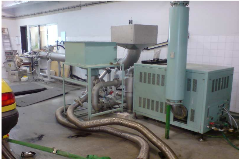
Εικόνα 4.3. Μονάδα δειγματοληψίας και αραιώσης των καυσαερίων.
