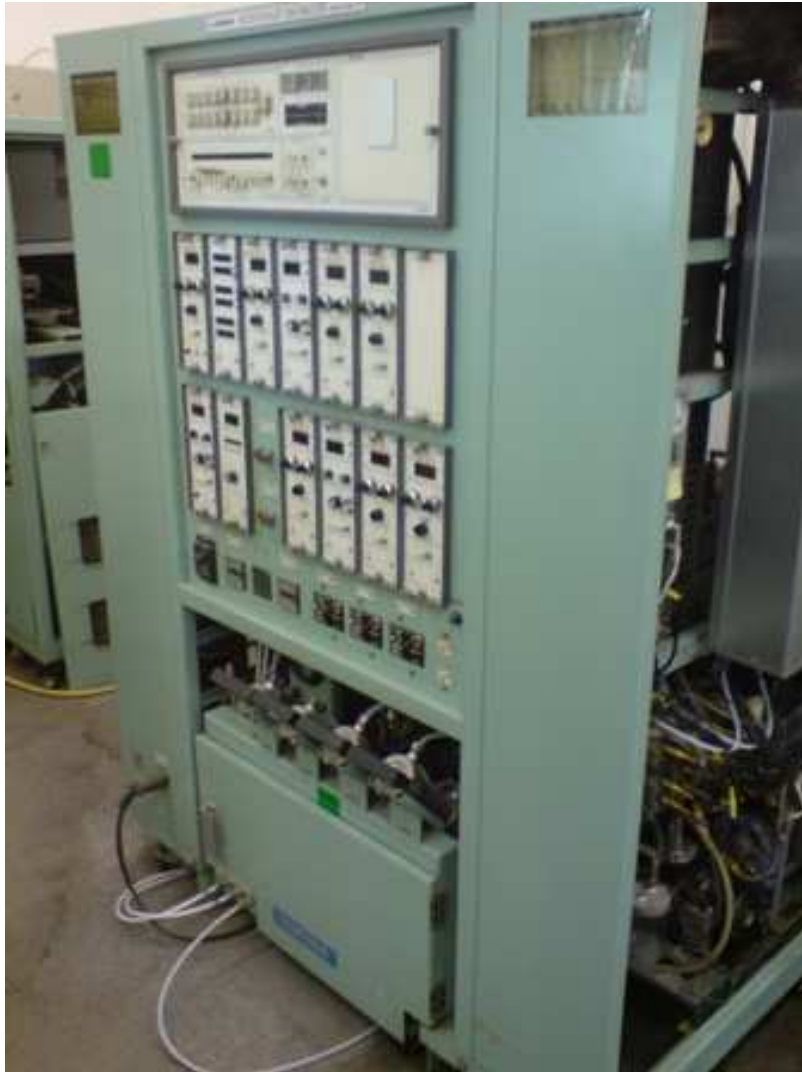
Εικόνα 4.4 Αναλυτής Καυσαερίων μοντέλο MEXA 8420 της HORIBA.(Εργαστήριο ελληνικού-παλαιά διάταξη)
