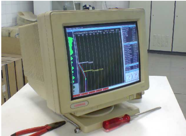
Εικόνα 4.5 Οθόνη βοήθειας (driver's aid) του οδηγού του οχήματος για την προβολή του κύκλου οδήγησης.
