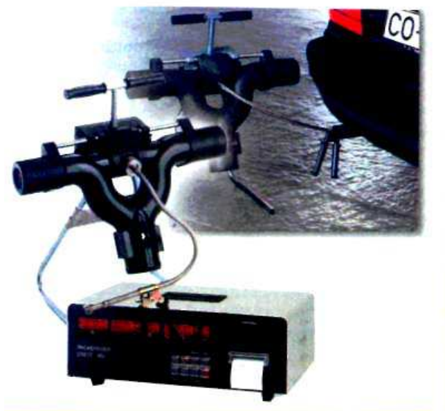
Εικόνα 3.7 Μέτρηση με αιθαλόμετρο.
