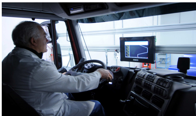
Εικόνα 3.1 Εφαρμογή κύκλου οδήγησης σε βαρέως τύπου οχήματος. 29
