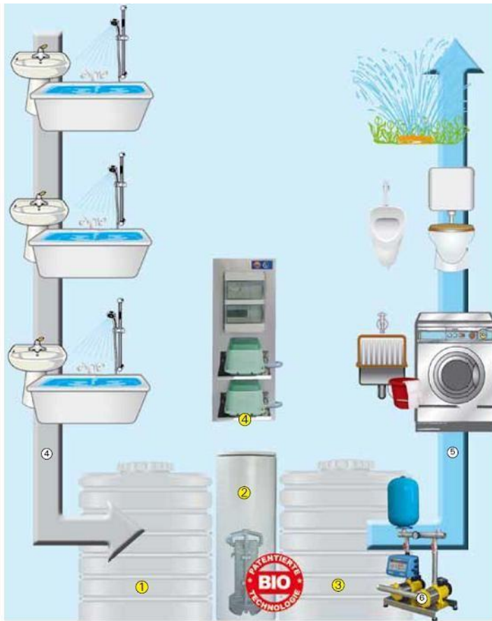
Επεξεργασία και ανακύκλωση γκριζου νερού με πατενταρισμένα συστήματα της εταιρίας GreenLife
