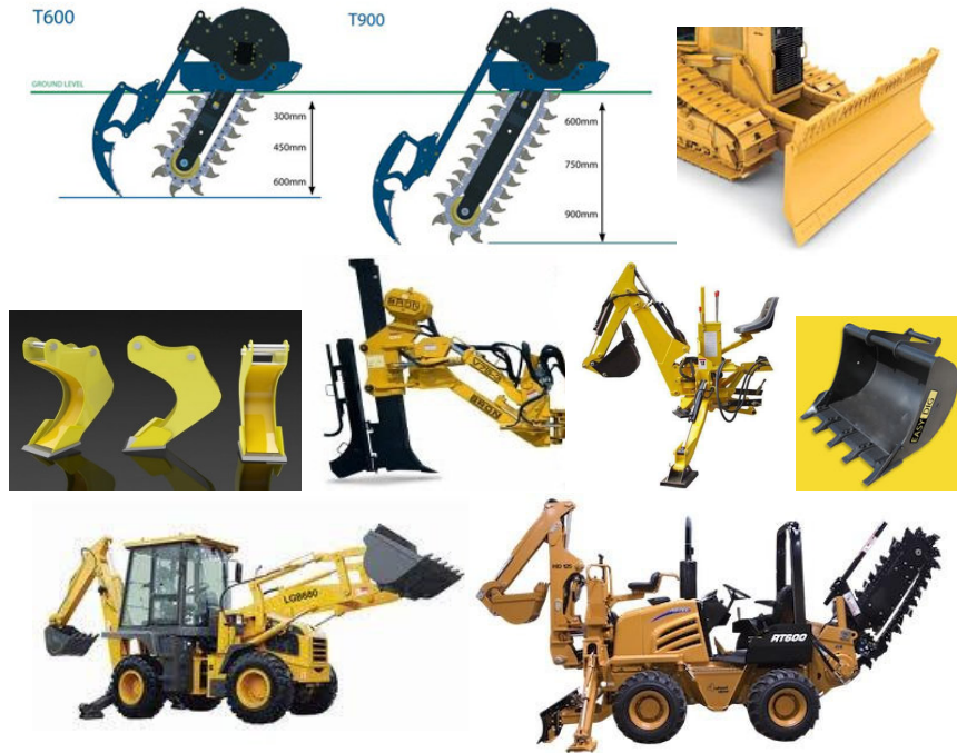
Εικόνες 6.8 Οχήματα και ειδικά εξαρτήματα χωματουργικών μηχανημάτων που χρησιμοποιούνται για εκσκαφές και μετακινήσεις χωμάτων.
