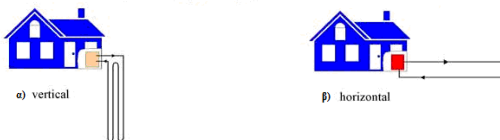
Σχήματα 4.1.1 Αντλίες θερμότητας συνδεδεμένες με το έδαφος (Ground Coupled Heat Pumps, GCHP), κλειστού βρόχου (Closed Loop Heat Pumps), συνδεδεμένες σε: α) κάθετη διάταξη, β) οριζόντια διάταξη.
