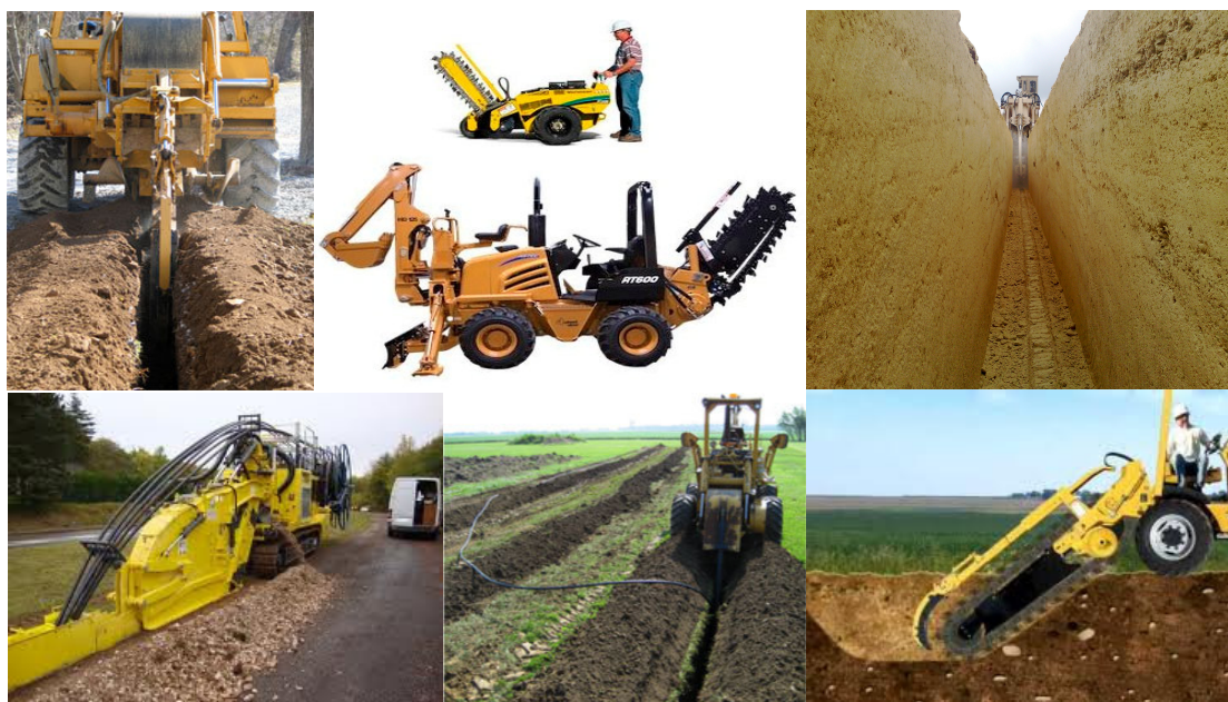
Εικόνες 6.10 Διάφοροι τύποι και μεγέθη, μηχανημάτων διάνοιξης τάφρων που μπορούν να χρησιμοποιηθούν ανάλογα με τις απαιτήσεις της εγκατάστασης.
