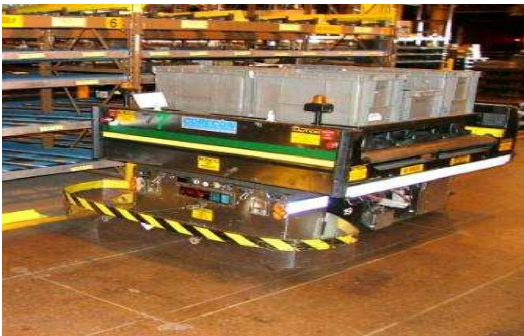
Αυτόματο αυτοκινούμενο βαγόνι μεταφοράς
