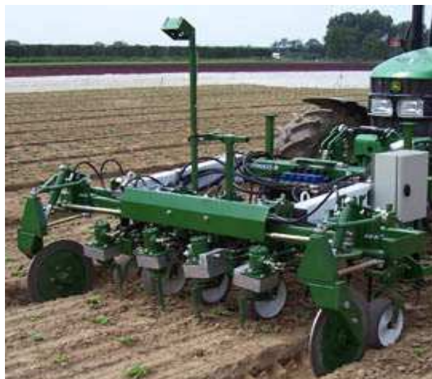
Ρομπότ απομάκρυνσης ζιζανίων με μηχανικό τρόπο
