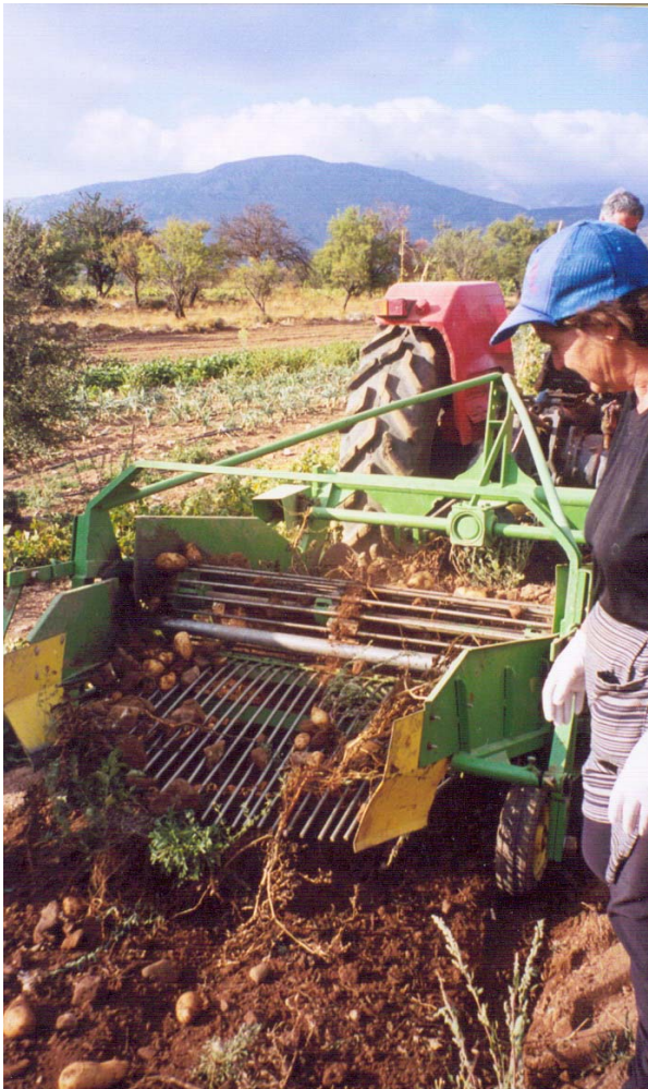
Εικόνα 58. Εξαγωγή των κόνδυλων από το έδαφος με τη βοήθεια πατατοεξαγωγέα.
