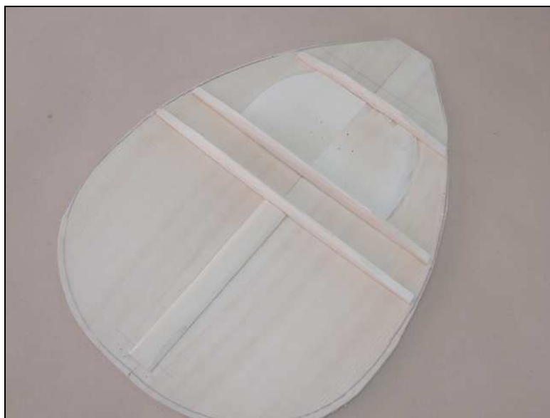
Εικόνα 4.15 Η ένωση των δύο κομματιών έλατου στο καπάκι και τοποθέτηση των καμαριών κάτω από το καπάκι.
