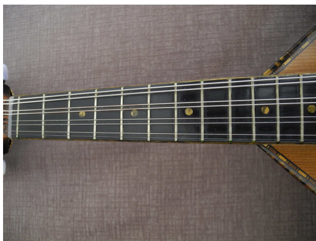
Εικόνα 4.27 Η ταστιέρα μετά την τοποθέτηση των τάστων στο μαντολίνο
