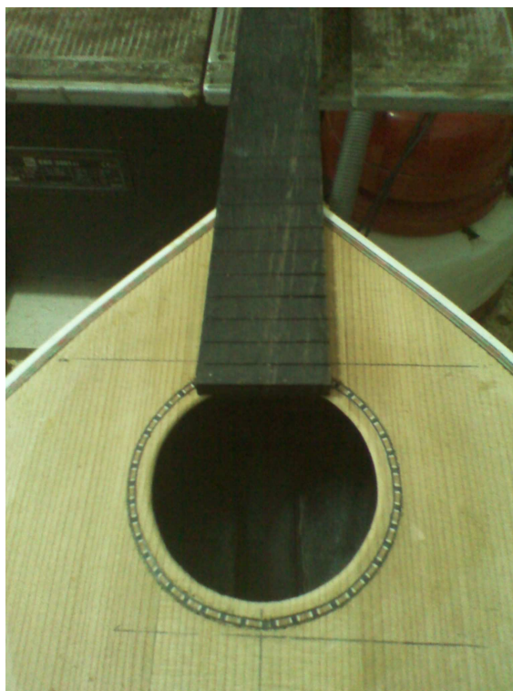
Εικόνα 4.25 Τοποθέτηση της ταστιέρας πάνω στο μαντολίνο
