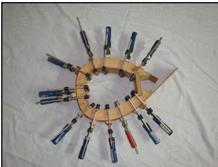
Εικόνα 4.11 Πιάσιμο των πλαϊνών με σφικτήρες στο καλούπι
