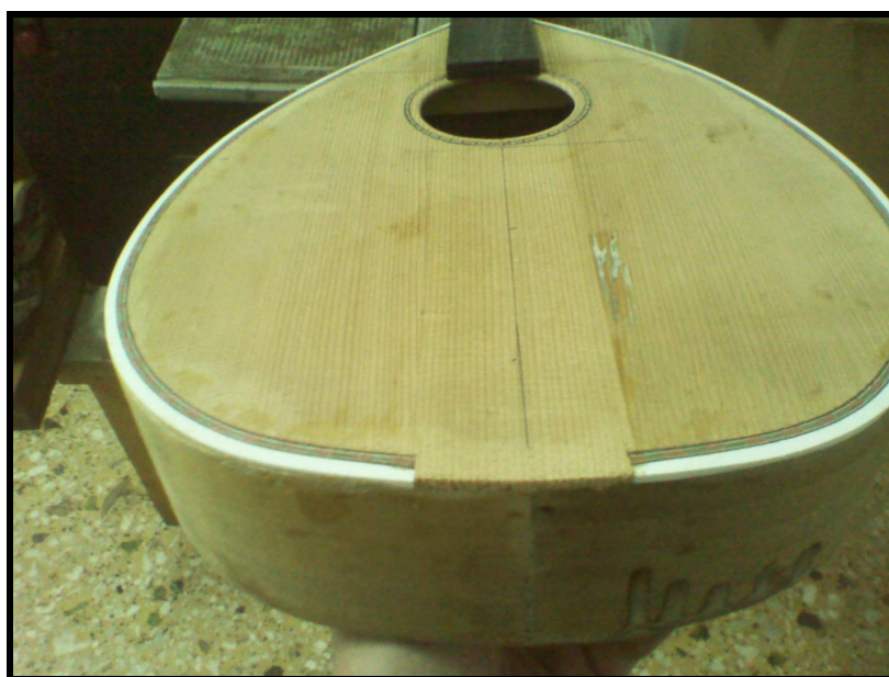
Εικόνα 4.16 Τοποθέτηση διακοσμητικών φιλέτων ξύλου περιμετρικά του καπακιού του μαντολίνου
