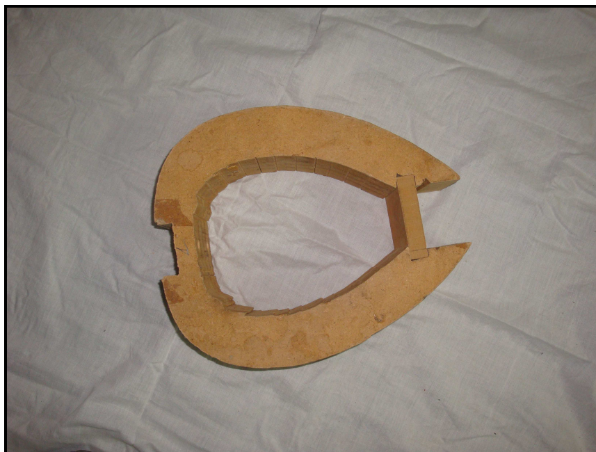
Εικόνα 4.9 Καλούπι με τις διαστάσεις του πλακέ μαντολίνου
