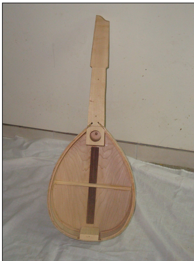
Εικόνα 4.12 Τοποθέτηση καμαριών μεταξύ της πλάτης και των πλαινών
