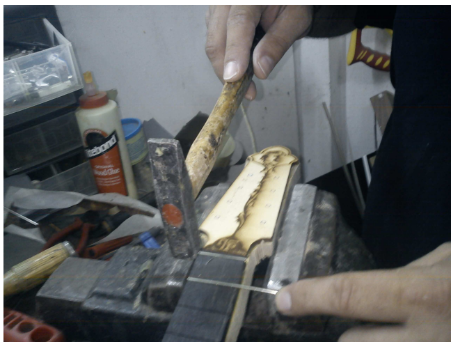
Εικόνα 4.26 Τοποθέτηση των τάστων πάνω στη ταστιέρα
