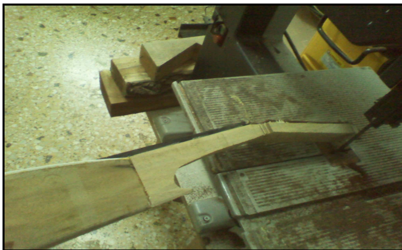
Εικόνα 4.20 Διαμόρφωση του μάνικου του μαντολίνου
