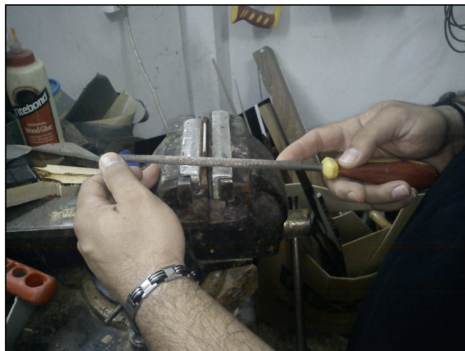
Εικόνα 4.30 Κατά την διαδικασία κατασκευής της γέφυρα των χορδών
