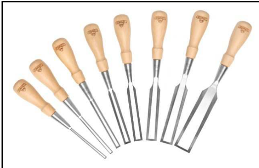
Εικόνα 4.2 Σκαρπέλα για χάραξη, διαμόρφωσης ξύλου
