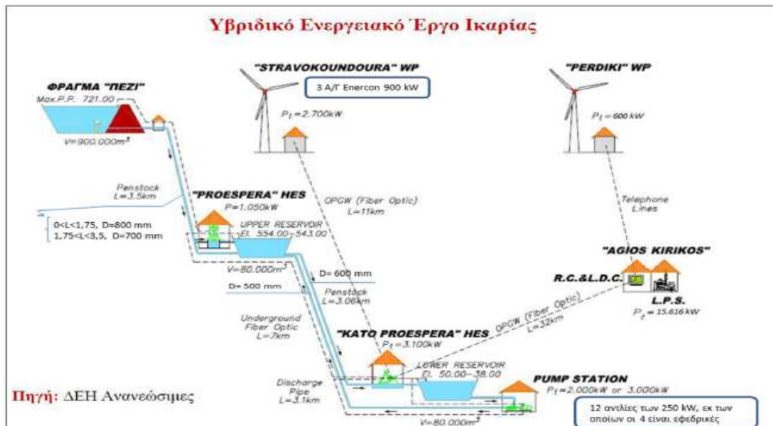
Σχήμα 3.13: Εσωτερική διαμόρφωση του ΥΒΕ και λοιπές μονάδες παραγωγής συστήματος της Ικαρίας 2013
