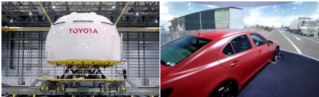
Εικόνα 1.4.2.1.: cockpit προσομοιωτή οδήγησης Toyota, εξωτερική μορφή - εσωτερική
