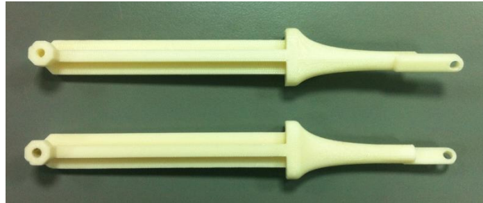
Εικόνα 3.1.2.3.2.2.: κατασκευασμένοι κινητοί σύνδεσμοι πρισματικής άρθρωσης (δρομείς)
