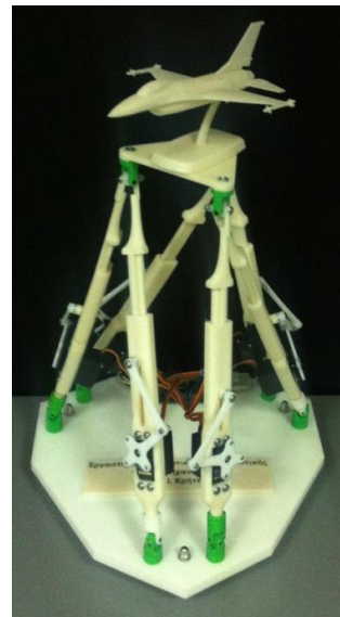
Εικόνα 5.2.6.2.: μέγιστη περιστροφή γύρω από τον κινούμενο άξονα των z της πλατφόρμας κατά γωνία \gamma^\circ < 0
