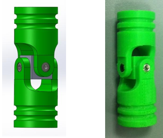
Εικόνα 3.1.2.4.3.: άρθρωση κάτω βάσης (διάταξη “σταυρός” Universal Joint) (σχεδιασμένη - κατασκευασμένη)
