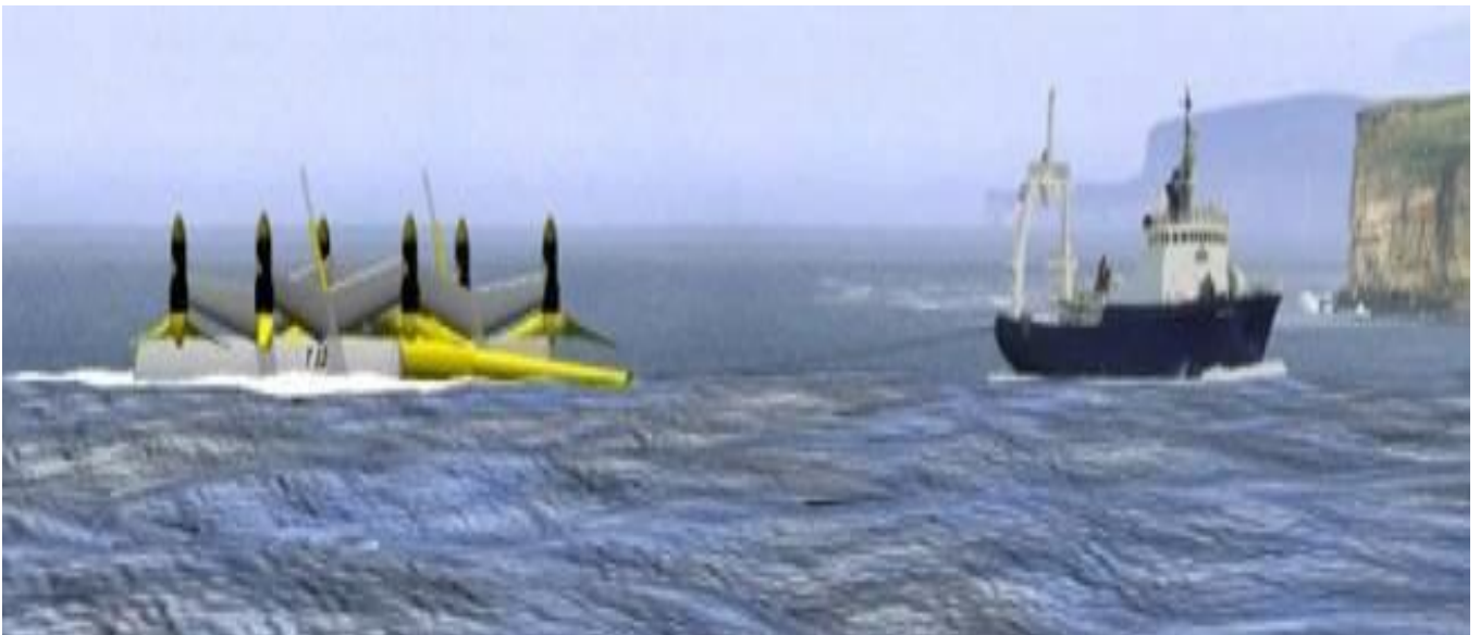
Εικόνα 3.8: Μικρό ρυμουλκό μεταφέρει τη συσκευή Triton 6 στην καθορισμένη θέση
