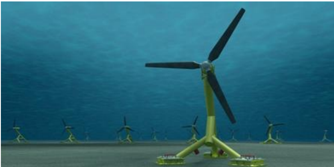
Εικόνα 3.4: Εγκατεστημένες συσκευές Hammerfest στο βυθό της θάλασσας
