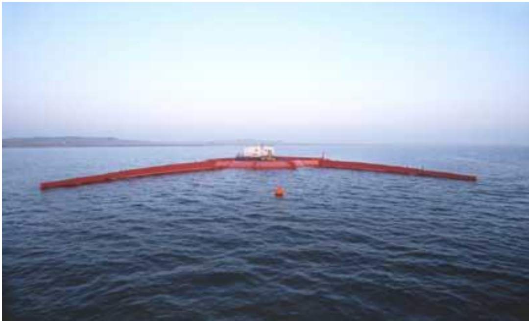
Εικόνα 4.11: Η πρόσοψη του μετατροπέα Wave Dragon στο Nissum Brending
