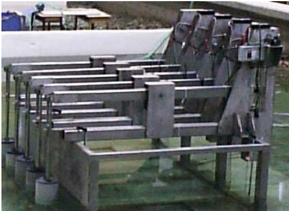
Εικόνα 4.16: Το δοκιμαστικό μοντέλο κλίμακας 1:15 εμπρός του κυματοθραύστη σε δεξαμενή δημιουργίας τεχνητών κυμάτων στο Μετσόβιο Πολυτεχνείο.
