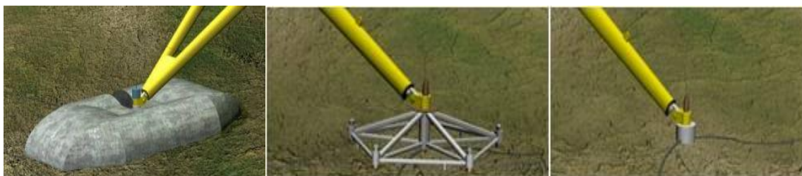
Εικόνα 3.7: Βάσεις στήριξης μόνο με τη βοήθεια της βαρύτητας, καρφωμένο πλαίσιο και με μονό πάσσαλο
