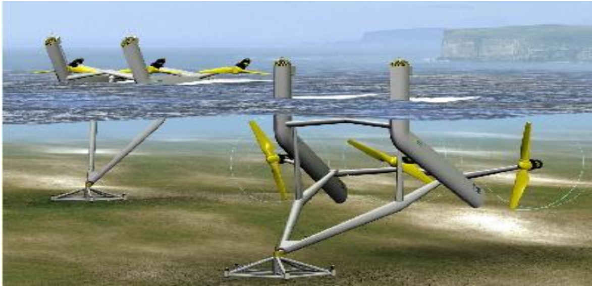
Εικόνα 3.6: Η συσκευή Triton 3 κατάλληλη για βάθος μεταξύ 35 – 55 μέτρα
