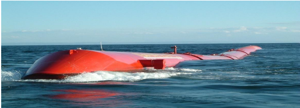
Εικόνα 4.31: Αρθρωτό σύστημα για την παραγωγή ηλεκτρικής ενέργειας
