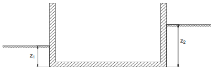
Σχήμα 3.2. Ενδεικτική διατομή κτιρίου για τον προσδιορισμό του το βάθους έδρασης πλάκας επί εδάφους με διαφορετικές στάθμες έδρασης λόγω κεκλιμένου εδάφους.
