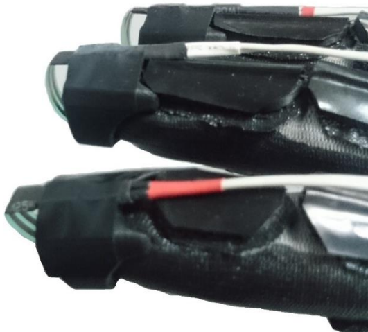
Εικόνα 3-7 Τοποθετημένοι αισθητήρες δύναμης
