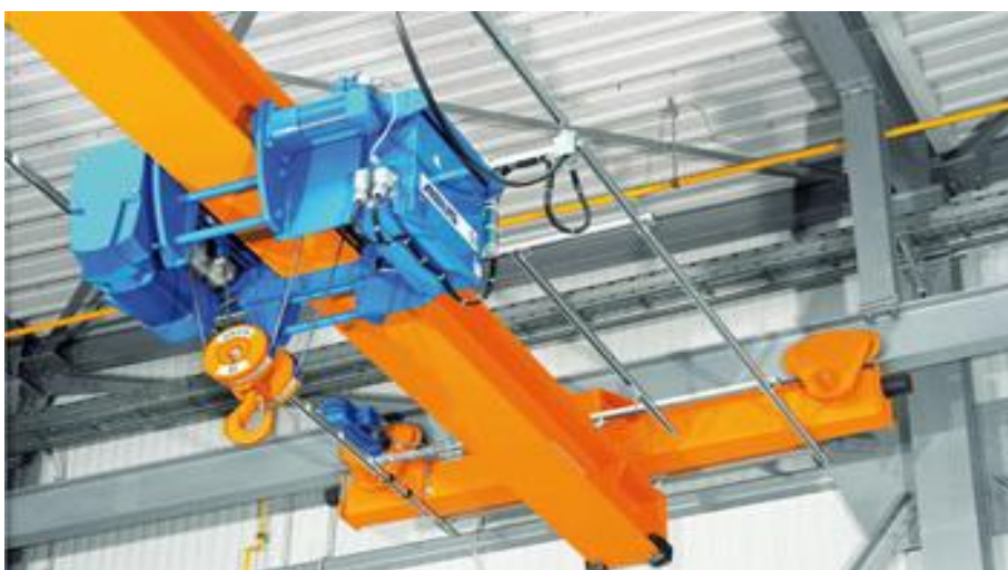
Εικόνα 3.3.2: Αναρτώμενη γερανογέφυρα μονού φορέα με αναρτώμενο φορέιο βαρούλκο
