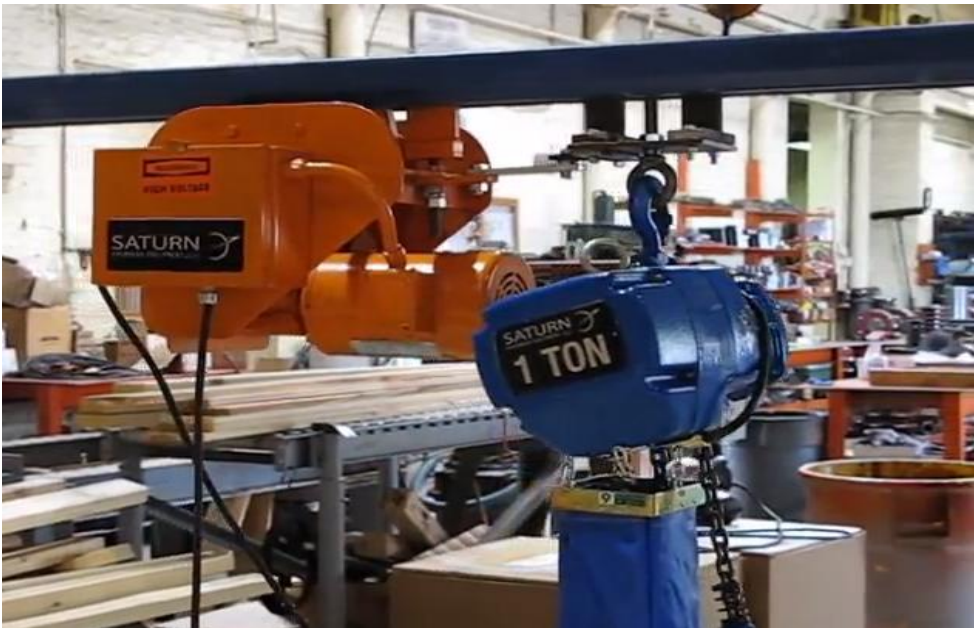
Εικόνα 5.5.3: Σύστημα με drive tractor που δίνει ηλεκτρική κίνηση στο βαρουλκοφορείο
