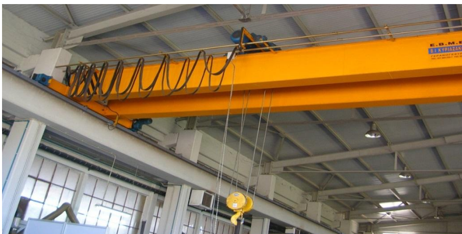
Εικόνα3.3.1: Επικαθήμενη γερανογέφυρα διπλής κατανομής με επικαθήμενο φορέιο βαρούλκου
