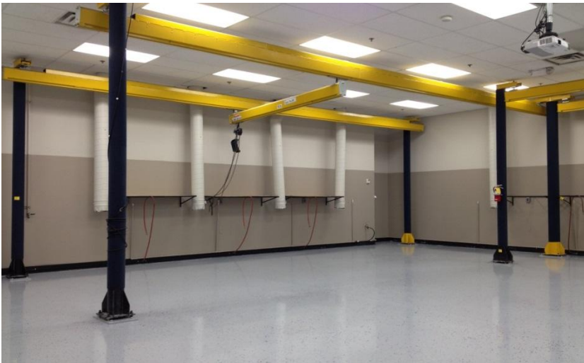
Εικόνα 5.1.3: Γερανογέφυρα με κοιλοδοκούς κύλισης, χειροκίνητη, απλής κατανομής και με αυτόνομη στήριξη
