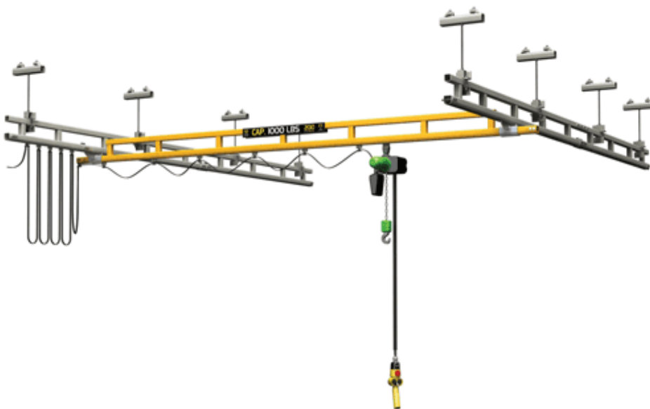
Εικόνα 6.1: Αναρτώμενη γερανογέφυρα μονού φορέα, με στήριξη στην οροφή και σύστημα κύλισης με κοιλοδοκούς
