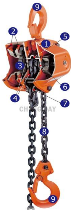
Εικόνα 3.2.1.4: Χειροκίνητος ανυψωτικός μηχανισμός που η ανύψωση γίνεται με το τράβηγμα της αλυσίδας (παλάγκο)
