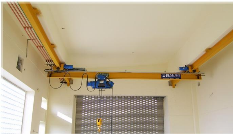
Εικόνα 5.1.2: Γερανογέφυρα αναρτώμενη, απλής κατανομής, με αναρτώμενο βαρουλκοφορείο και με στήριξη στην οροφή
