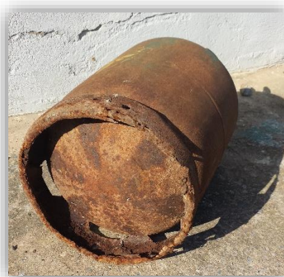
Εικόνα 49. Φιάλη με διαβρωμένο πάτο
