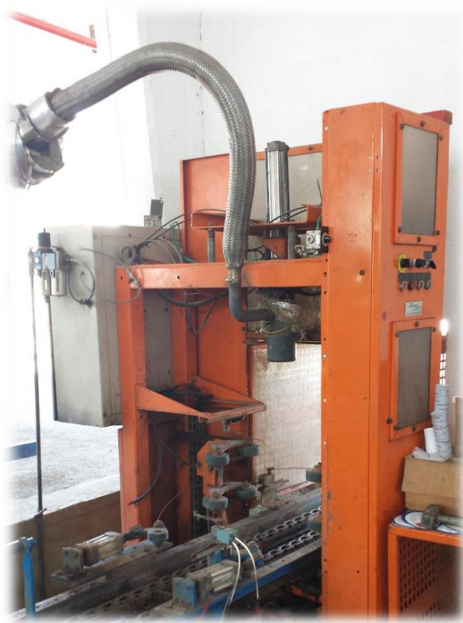
Εικόνα 37. Μηχάνημα εφαρμογής συρρικνωτικής μεμβράνης ασφαλείας
