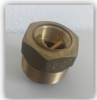
Εικόνα 39.Βαλβίδα απομόνωσης ασφαλιστικής βαλβίδας ανακούφισης
