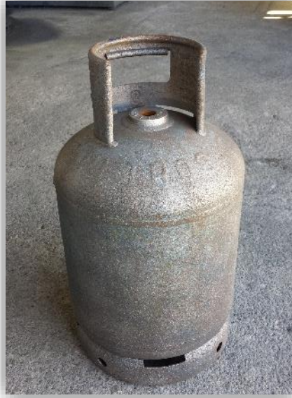
Εικόνα 51. Φιάλη που έχει περάσει το στάδιο της αμμοβολής
