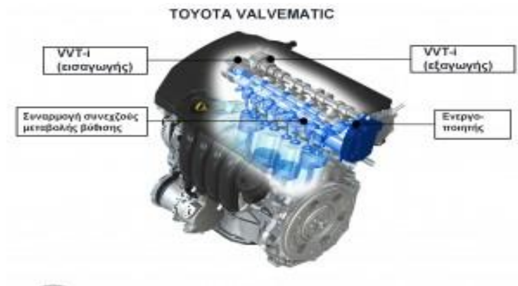
Εικόνα 5.19 : Το Σύστημα Μεταβλητού Χρονισμού VVT-i
