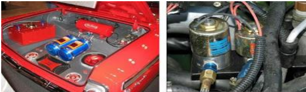
Εικόνα 4.26: Το Εγκατεστημένο Σύστημα Χημικής Υπερτροφοδότησης
