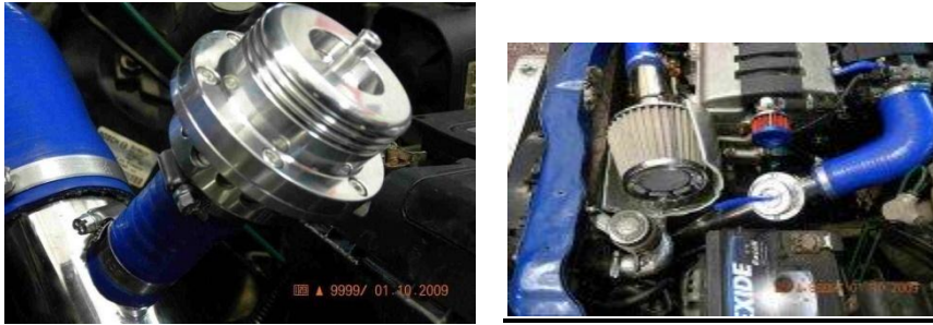
Εικόνα 4.13 Blow off valve
