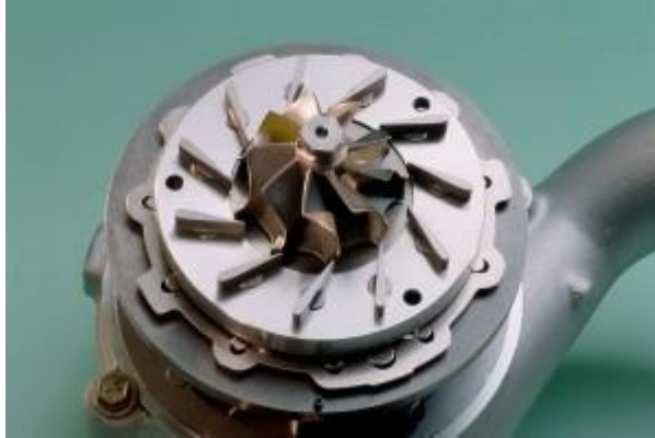
Εικόνα 2: Η VTG (Variable Turbo Geometry)
