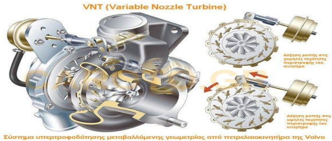
Εικόνα 3: Η VNT (Variable Nozzle Technology)
