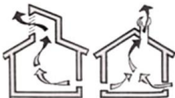
Σχήμα 4.9 Φυσικός ελκυσμός με πύργο αερισμού
