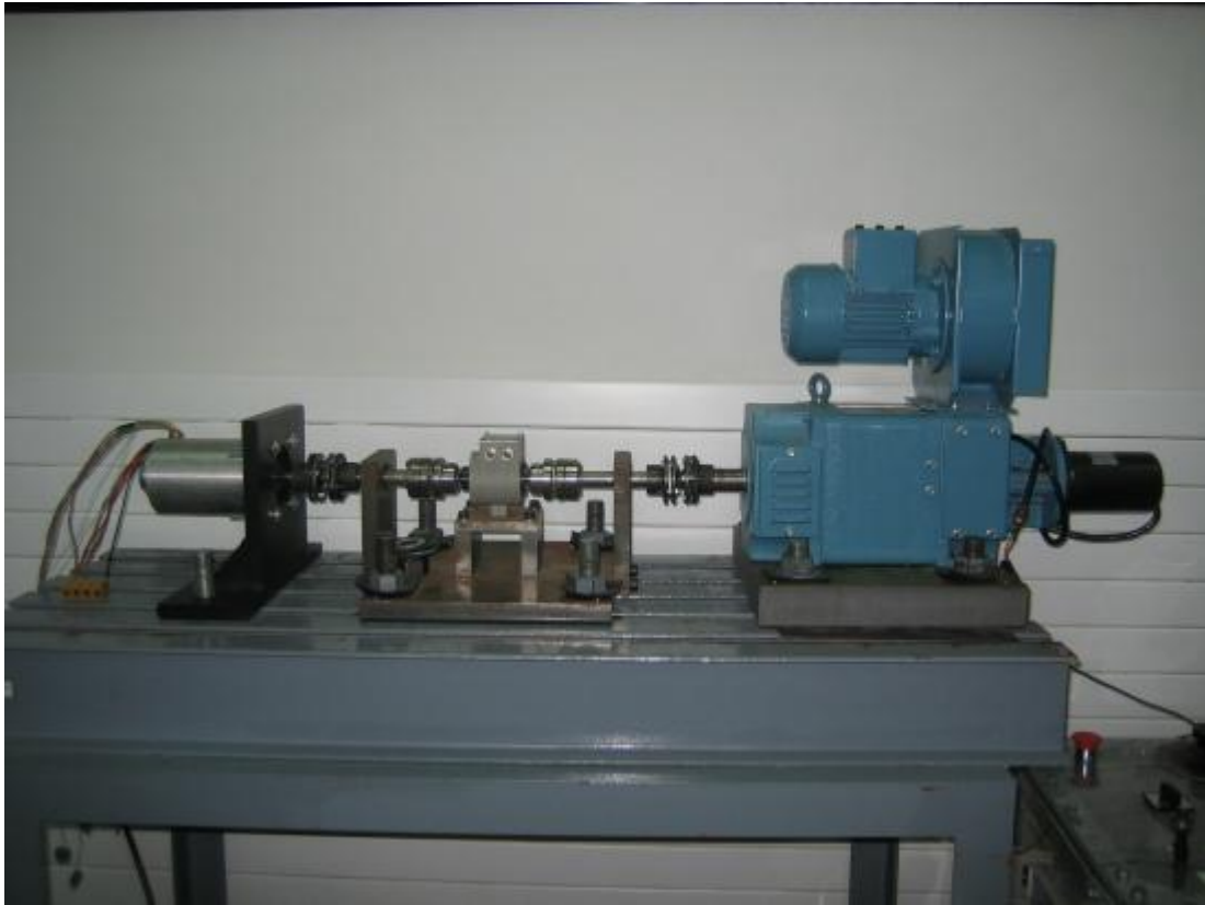
6.1.2.1β.1 Ροπόμετρο σε πειραματική διάταξη
