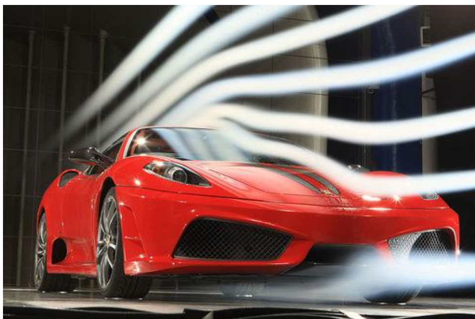
2.3.1 Εμφάνιση γραμμών ροής με χρήση καπνού.
