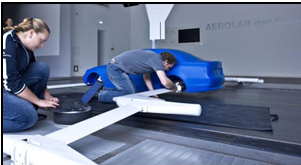
2.1.1 Κατασκευή μοντέλου για αεροδυναμικές μετρήσεις.
