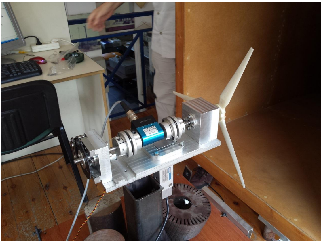
7.4.4 Μετρητική διάταξη στην αεροσήραγγα
