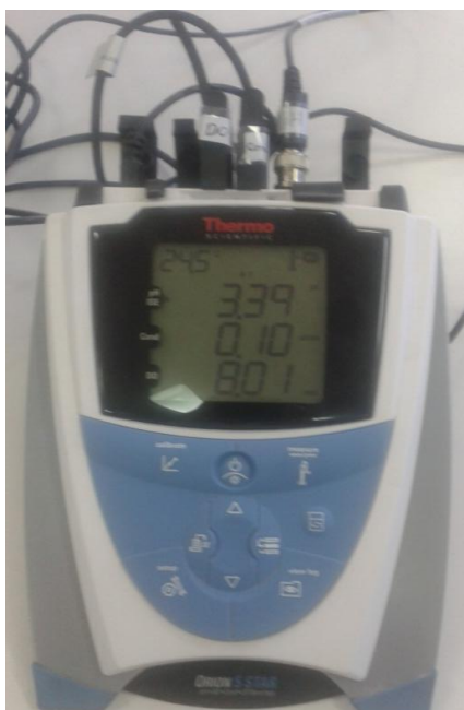
Εικόνα 1. Όργανο μέτρησης pH, αγωγιμότητας και διαλυμένου οξυγόνου στο νερό
