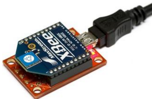
Εικόνα 5.10. Παράδειγμα σύνδεσης του XBee Explorer Dongle με τον υπολογιστή.
