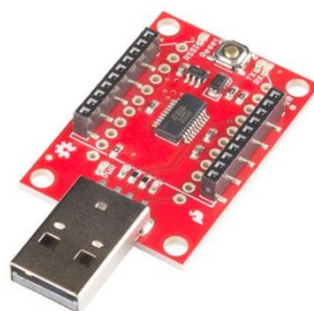
Εικόνα 5.9. Πλακέτα σύνδεσης XBee Explorer USB για σύνδεση του XBee με Η/Υ .
