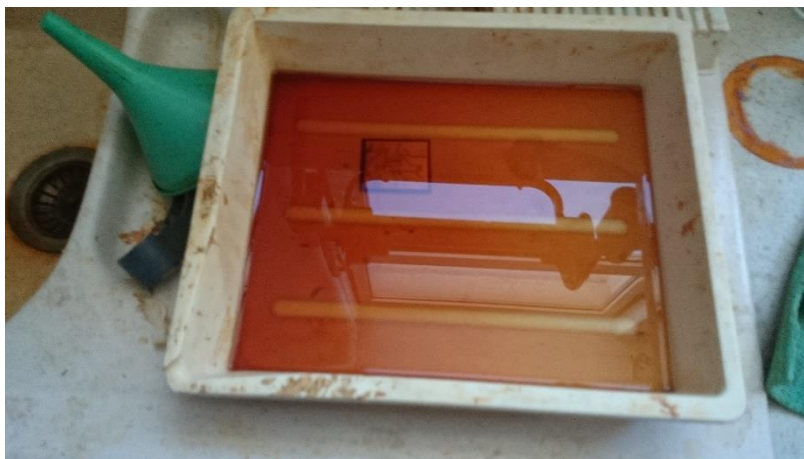
Εικόνα 0.5. Πλακέτα εκτυπωμένου κυκλώματος τοποθετημένο σε μίγμα υδροξειδίου του νατρίου.
