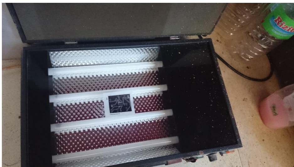
Εικόνα 0.4. Εκτυπωμένο σχέδιο τοποθετημένο στην μηχανή έκθεσης φωτός UV.
