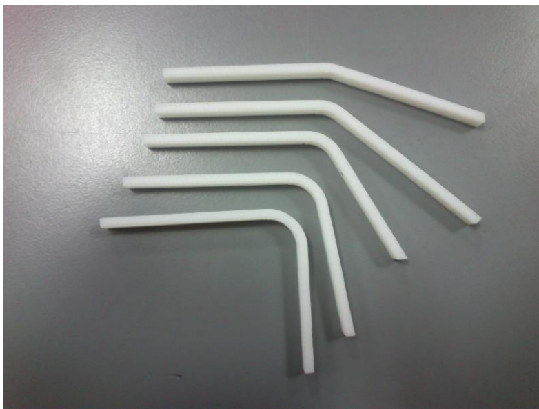
Εικόνα 4.4. Εκτυπωμένες επιφάνειες από τον τρισδιάστατο εκτυπωτή με ακτίνα καμπυλότητας 15mm.
