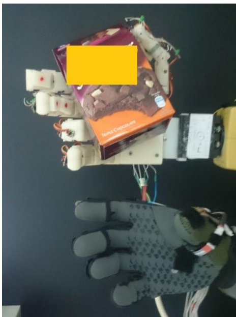
Εικόνα 5.30. Ευσταθής λαβή χάρτινου κουτιού με το ρομποτικό χέρι και το γάντι συλλογής δεδομένων.
