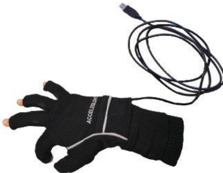
Εικόνα 2.9. Γάντι συλλογής δεδομένων AcceleGlove.
