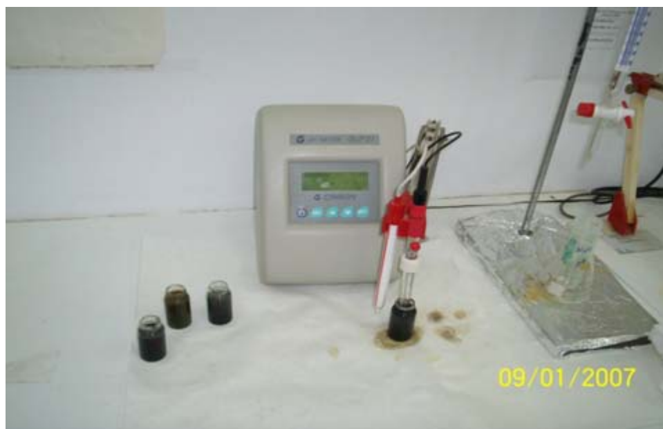
Σχήμα 10. Συσκευή μέτρησης της τιμής του pH
