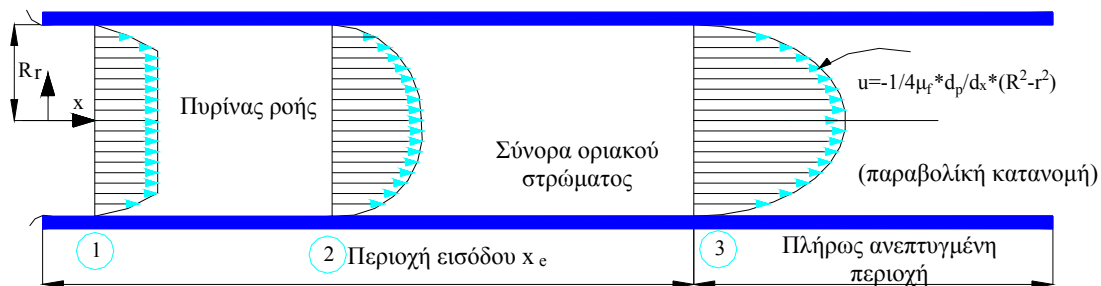
Σχήμα 2. Στρωτό υδροδυναμικό οριακό στρώμα στην περιοχή ανάπτυξης του μέσα σε κυκλικό αγωγό
