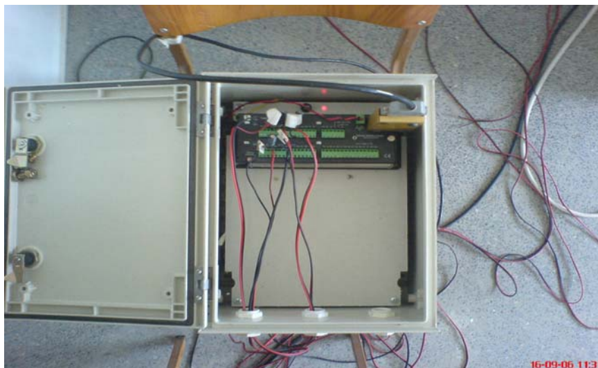
Εικόνα 4.8. Data logger Campbell για καταγραφή εξόδου ανεμογεννήτριας
