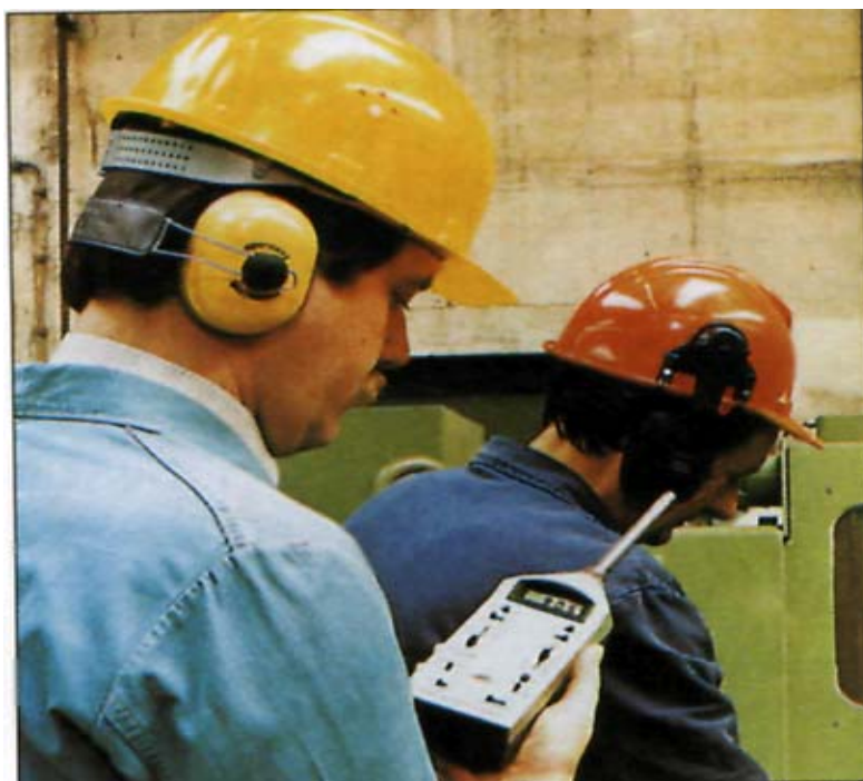
Σχ. 6.2.1 Ολοκληρωτικά ηχώμετρα- κατάλληλα όργανα για τη μέτρηση θορύβου
