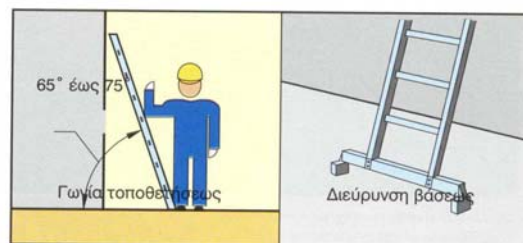
Σχήμα 3: Ασφαλής τοποθέτηση σκάλας
