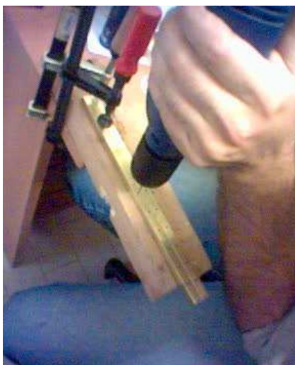
Τρύπημα των κεντρικών σωλήνων τροφοδότησης.
