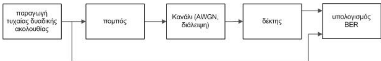
Σχήμα 8.3 Μέθοδος καθορισμού του bit-error-rate.
