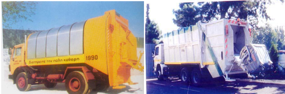
Εικόνα 2.4: Κλειστά απορριμματοφόρα τύπου: Α)μύλου, Β)πρέσας
