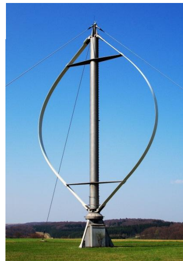
Εικόνα 2. Ανεμογεννήτρια κατακόρυφου άξονα
