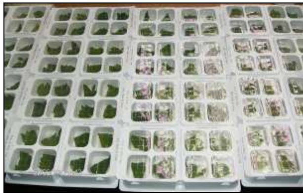
Εικόνα 38: Δίσκοι τοξικολογικών βιοδοκιμών με 32 κελιά και κολλητικά καπάκια ανά 4 θέσεων (8 καπάκια ανά δίσκο) (BioServ Rearing Tray RT32W, closed with lids RTCV4).
