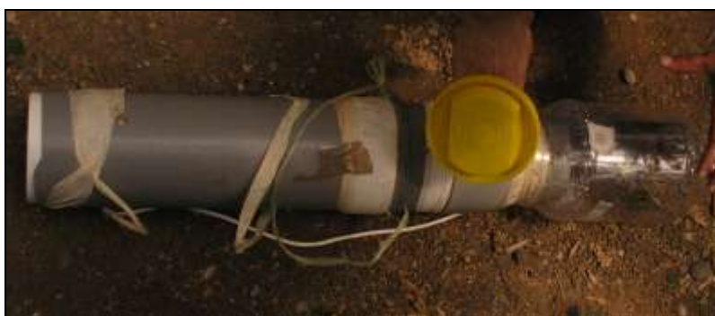
Εικόνα 25: Συσκευή αναρρόφησης για συλλογή ενήλικων ατόμων T. absoluta , με εμφανή τον ειδικό προσαρμογέα. Στη φωτογραφία απεικονίζεται η διαδικασία της εξόδου των ενήλικων ατόμων από τη συσκευή αναρρόφησης στο πλαστικό δοχείο.
