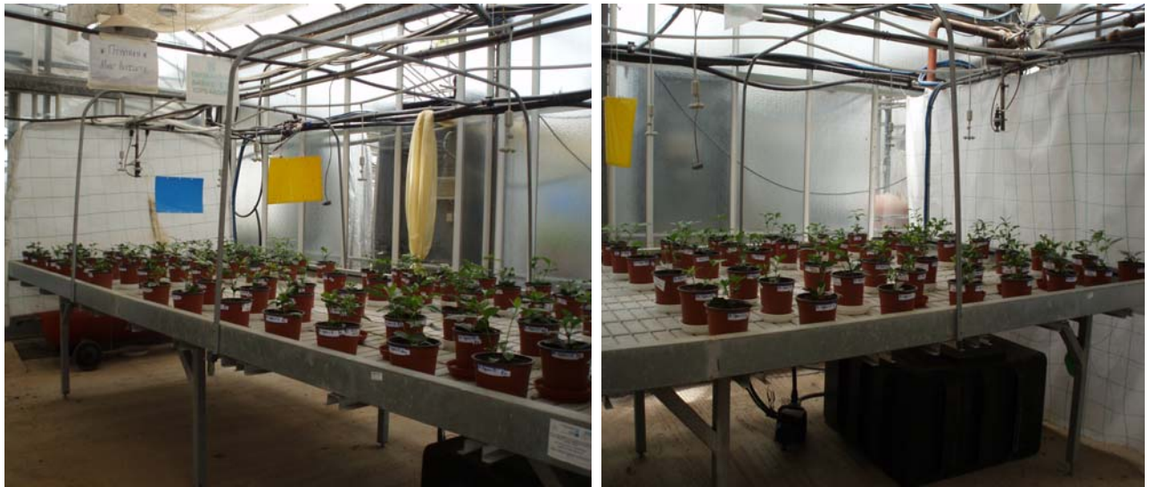
Εικόνες 13 & 14. Τράπεζα καλλιέργειας φυτών (πειράματος 1) ebb and flow (αριστερά) με το αντίστοιχο πλαστικό δοχείο 500lt (δεξιά) παρασκευής θρεπτικού διαλύματος στην κάτω μεριά.
