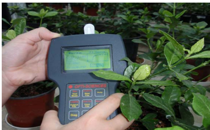
Εικόνα 17. Μέτρηση σχετικού φθορισμού χλωροφύλλης ( F_v/F_{max} ) στα φύλλα των φυτών (πειράματος 2) με φορητό chlorophyll fluorometer.
