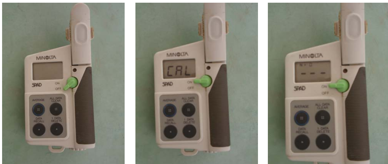
Εικόνες 20& 21& 22. Στάδια λειτουργίας φορητού οργάνου χλωροφυλλόμετρου SPAD-502 leaf chlorophyll meter για τη μέτρηση της πυκνότητας της χλωροφύλλης.
