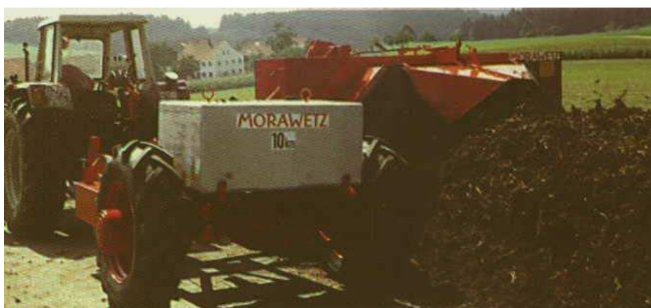
Εικόνα 11 Αναστροφέας σωρών κομποστοποίησης για γεωργικούς ελκυστήρες με έρπουσα ταχύτητα..
