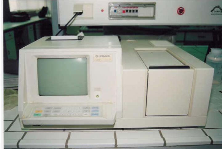
Εικόνα 9: Φασματοφωτόμετρο ορατού-υπεριώδους, διπλής δέσμης, με ενσωματωμένο μικροϋπολογιστή , εκτυπωτή-καταγραφέα και οθόνη παρουσίασης δεδομένων και καμπυλών.
